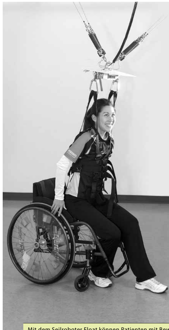
Mit dem Seilroboter Float können Patienten mit Bewegungseinschränkungen das aufrechte Gehen trainieren.
